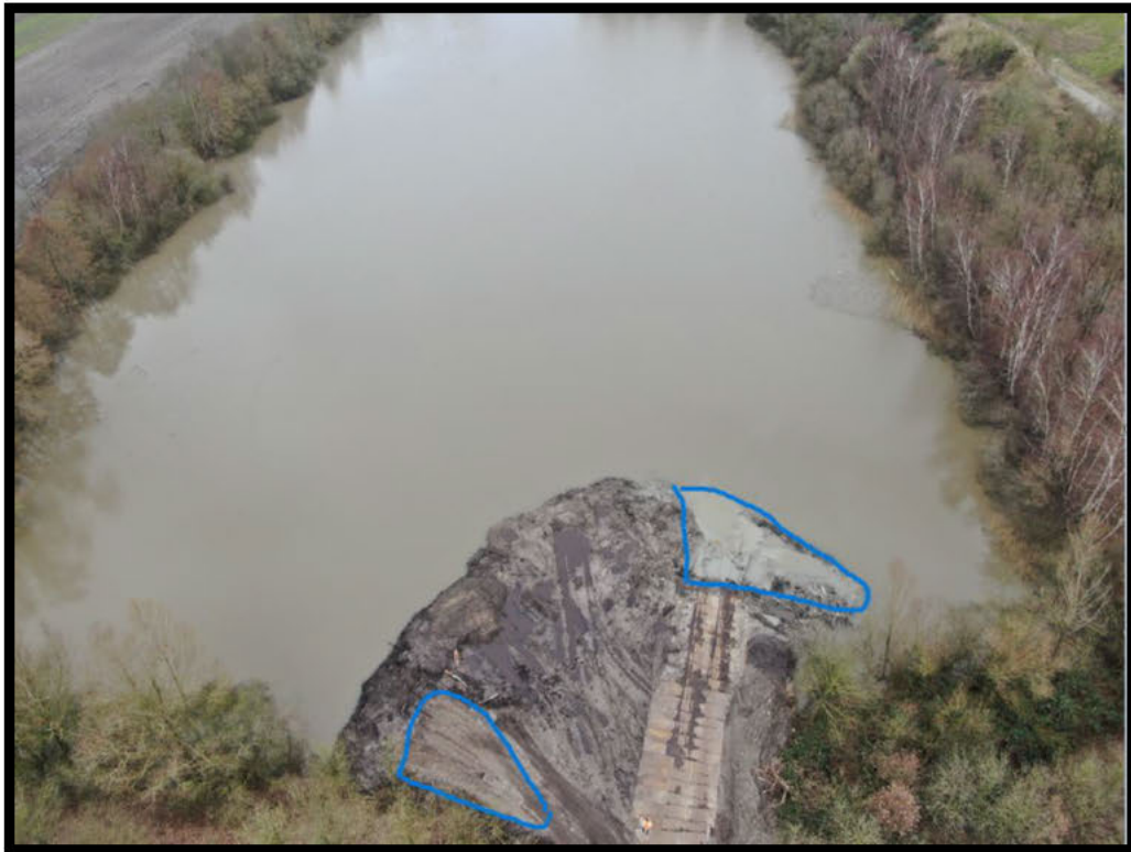
Foto 5 (dronefoto): Toepassingslocatie Schippersplas geen doorzicht in het oppervlaktewater. Het oppervlaktewater is grauw van kleur. Links bouw omcirkeld is een bouwstof zijnde gebroken puin toegepast. Rechts blauw omcirkeld mogelijk vloeibare bentoniet toegepast.
