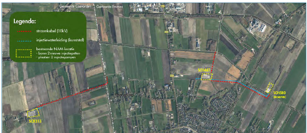
Figuur 1: Ligging NAM Schoonebeek-313 (SCH313), tracé Schoonebeek-447 (SCH447) naar Schoonebeek-580 (SCH580), aan de leggen stroomkabels, en aan te sluiten injectiewaterleidingen. Bron: Nederlandse Aardolie Maatschappij B.V.
