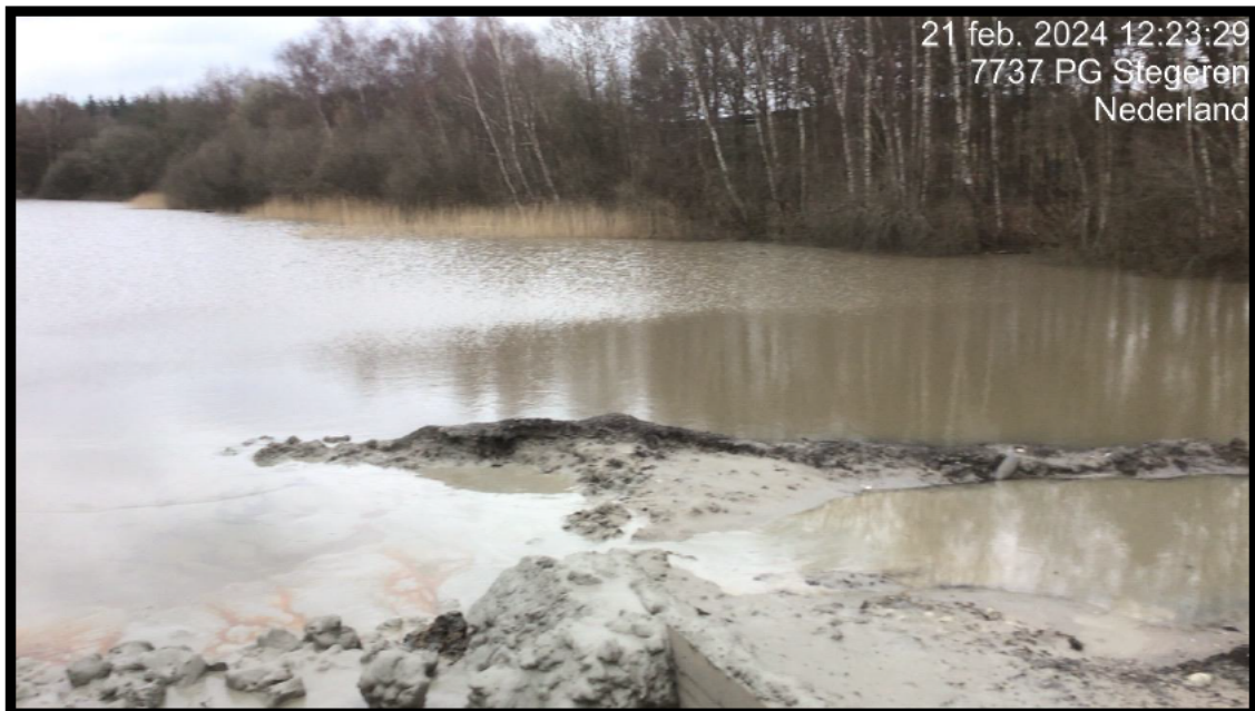
Foto 11: Toepassingslocatie Schippersplas geen doorzicht in het oppervlaktewater. Het oppervlaktewater is grijs van kleur.
