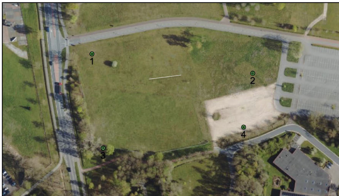
Figuur 2 – Voorstel locaties onttrekkingsbronnen
