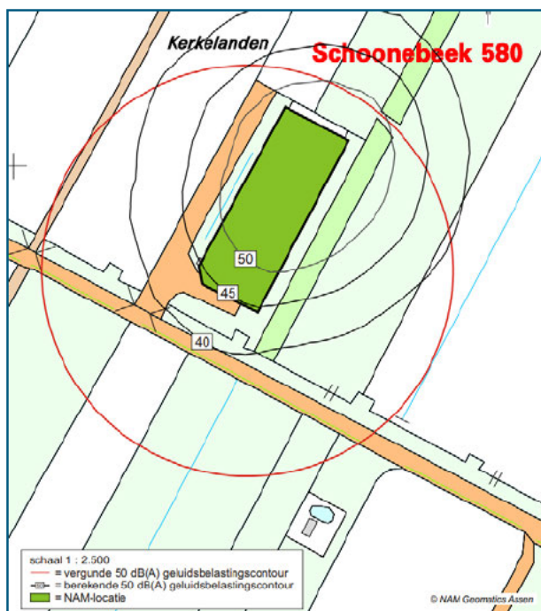
Figuur 5-4. Berekende geluidscontouren rondom SCH-580 in de operationele fase voor waterinjectie met 2 waterinjectieskids. De grijze cirkels geven de berekende 50, 45 en 40 dB(A). De rode cirkel geeft de vergunde 50 dB(A) contour aan.
