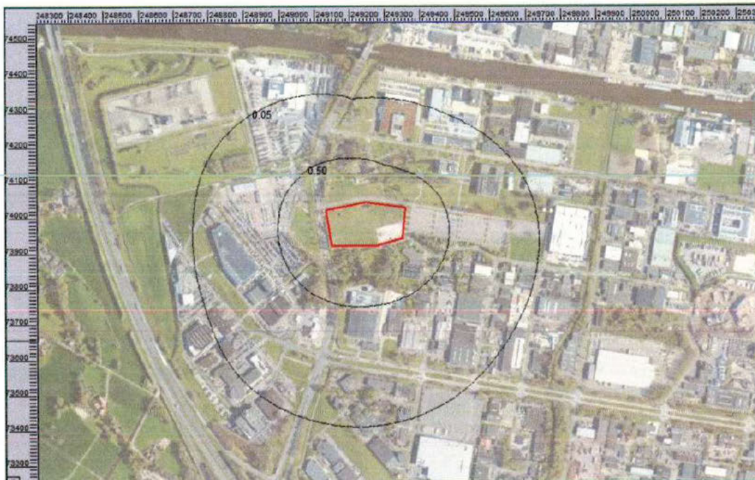
Afbeelding 1.1: Locatieoverzicht en de maximale grondwaterverlaging in 2028
