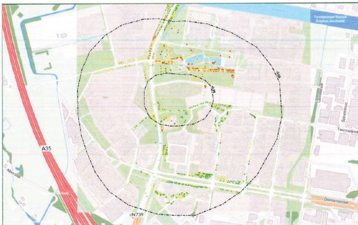
Afbeelding 4.2; Maximale grondwaterdaling in 2028
