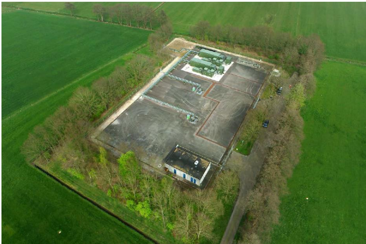
Figuur 2. Voorbeeld van een waterinjectielocatie met waterinjectieskids
